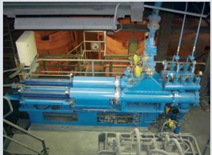
Dosierförderanlage bei ThyssenKrupp Steel
